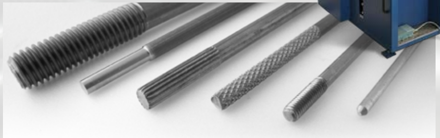
Gewindewalzen, rändeln, entgraten, spitzen
